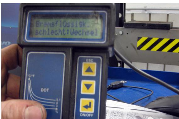
Messgerät zur Überprüfung der Bremsflüssigkeit
