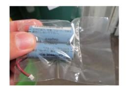
Möglichkeit einer kurzschlusssicheren Ladung – in Folie verpackt
