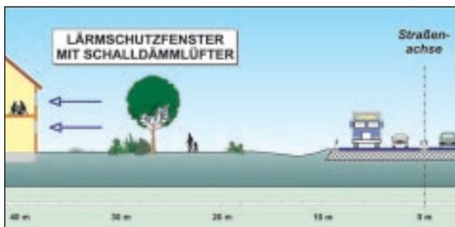
Abbildung 45: „Lärmschutzfenster in Verbindung mit Schalldämmlüftern reduzieren den Schallpegel in den Wohn- und Schlafräumen (Kirisits)“
