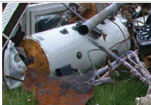
Elektrischer Warmwasserboiler (mit Isolierung und einem eingebauten Quecksilberdampfdruck-Schalter)
