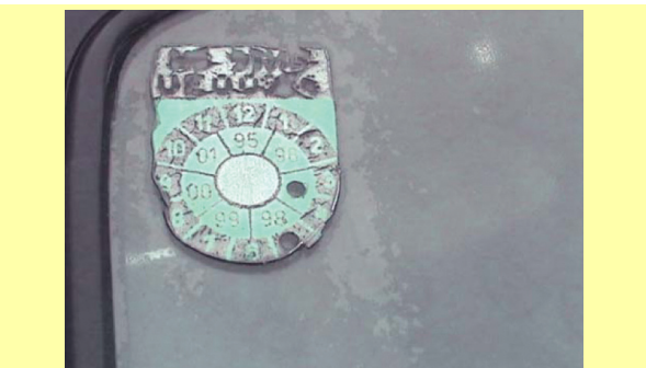
Abgelaufene und unkenntliche Prüfplakette
