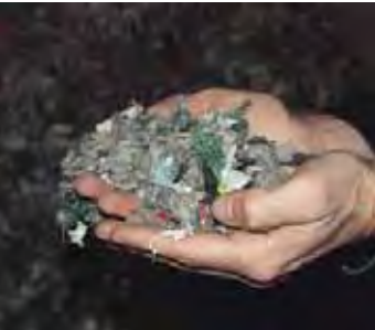
Qualitätsgesicherter Ersatzbrennstoff aus heiz- wertreichen Abfällen für die Zementindustrie.
