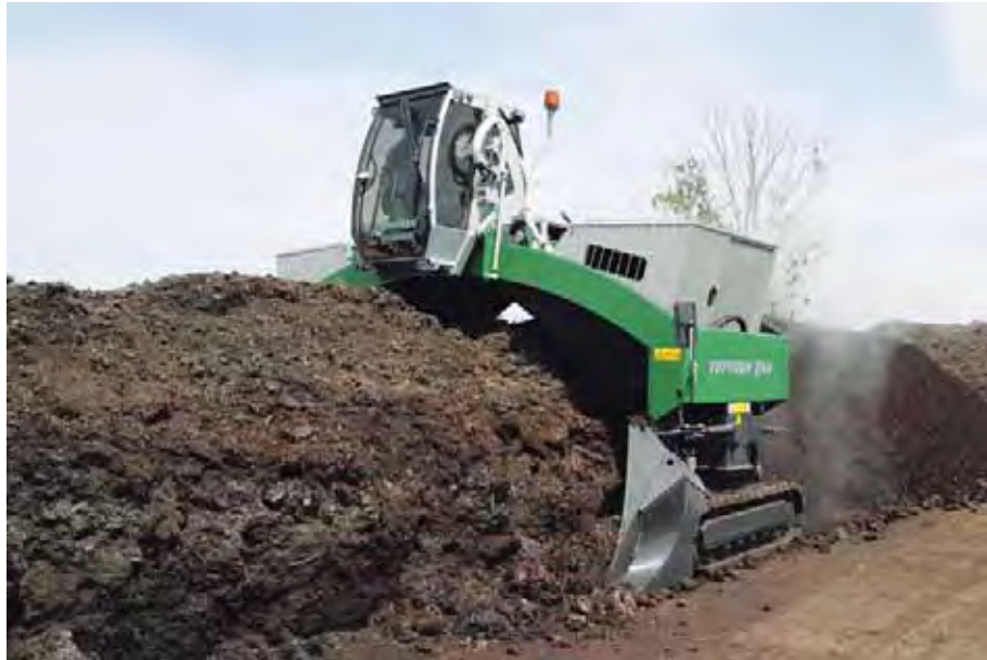
Selbstfahrende Wendemaschine Topturn-X-7 (Foto: Fa. Komptech, Frohnleiten).
