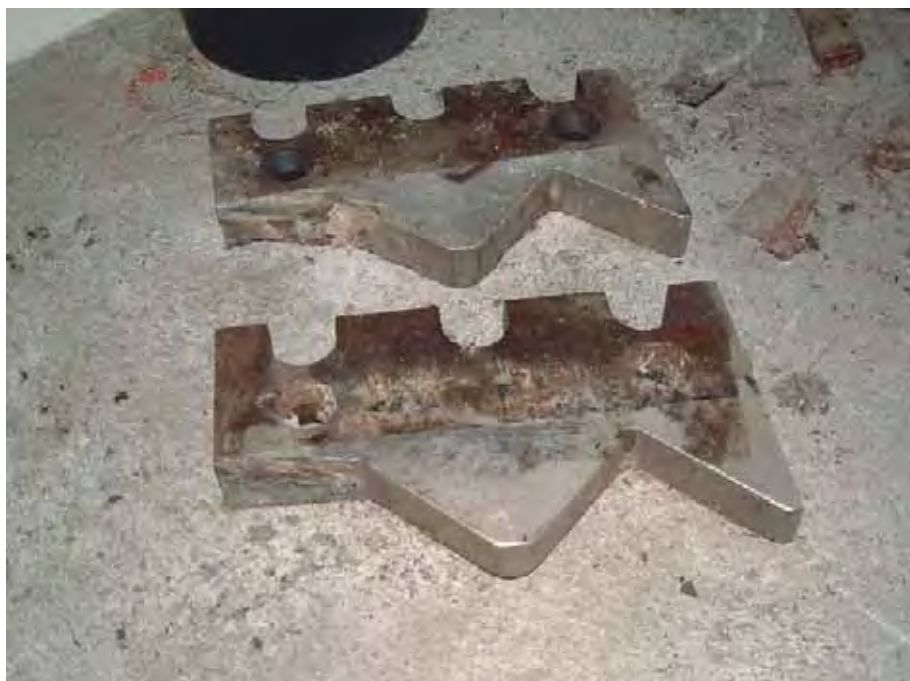
Abgebrochener Schneidezahn des Vorzerkleinerers der Müllanlage Liezen (Foto: AWW Liezen).
