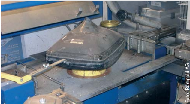
Zerlegung von Bildschirmgeräten
