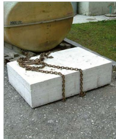
Abb. 50: ASZ Eisbach – angekettete Betonplatte zur Verdichtung.
