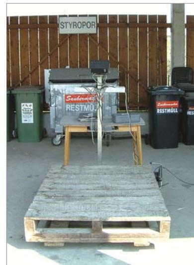
Abb. 30: ASZ Stainz - digitale Plattformwaage.
