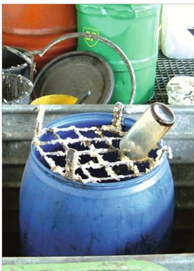
Abb. 100: ASZ Gröbming - Entleerungsrost für Alt Speiseölf Flaschen.
