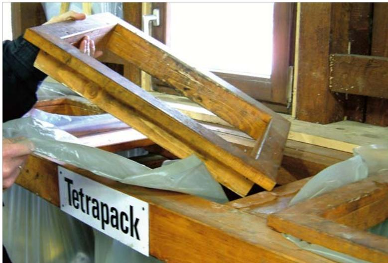
Abb. 84: ASZ Aigen –in Eigenregie konstruiertes Sackaufhängungssystem.
