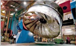
Turbinen von ANDRITZ für weltgrößtes Pumpspeicherkraftwerk
