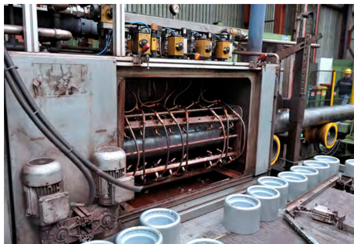
Rohrwaschanlage voestalpine Tubulars GmbH & Co KG
