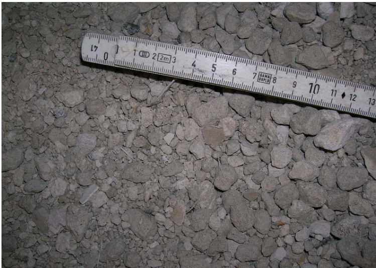
Abb: 2 – 4: Aufnahmen von der Versuchsführung und dem gewonnenen Gipsrecyclat
