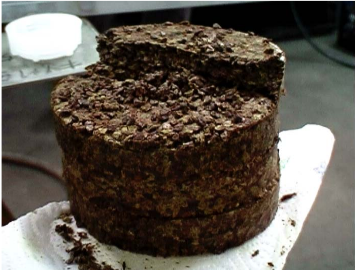
Abbildung 7: Presskuchen aus der Pressung von (nicht vorbehandelten) Schilcher-Traubenkernen mittels Stempel-(Zylinder-)presse.
