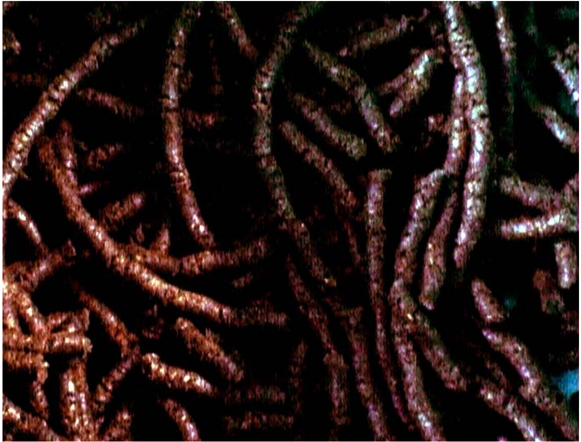
Abbildung 6: Typisches Aussehen eines Traubenkernpresskuchens aus der Pressung mit einer Schneckenpresse.
